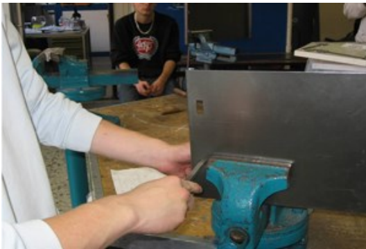
Herstellen einer Metallverkleidung.
